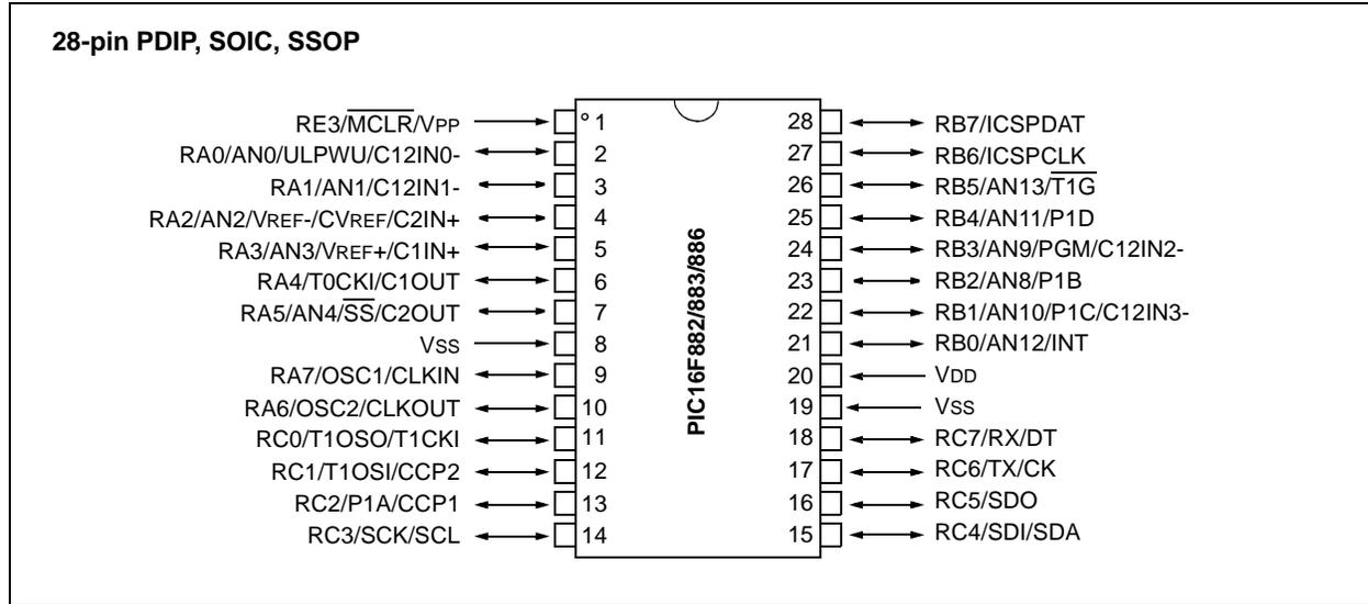
**TABLE 1: PIC16F882/883/886 28-PIN SUMMARY (PDIP, SOIC, SSOP)**
