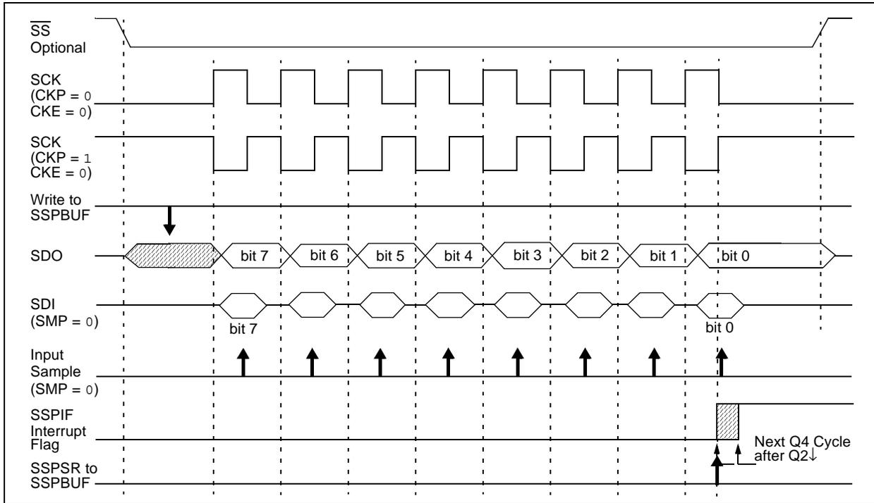
**FIGURE 19-6: SPI MODE WAVEFORM (SLAVE MODE WITH CKE = 1)**
